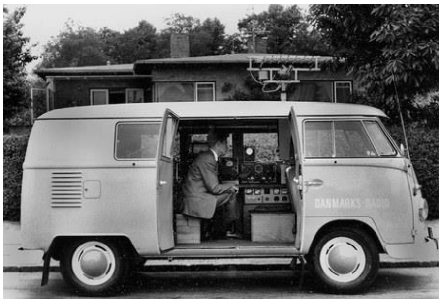
Pejlevognen med drejelig pejleantenne på taget og varerummet spækket med teknisk udstyr. Pressefoto.
