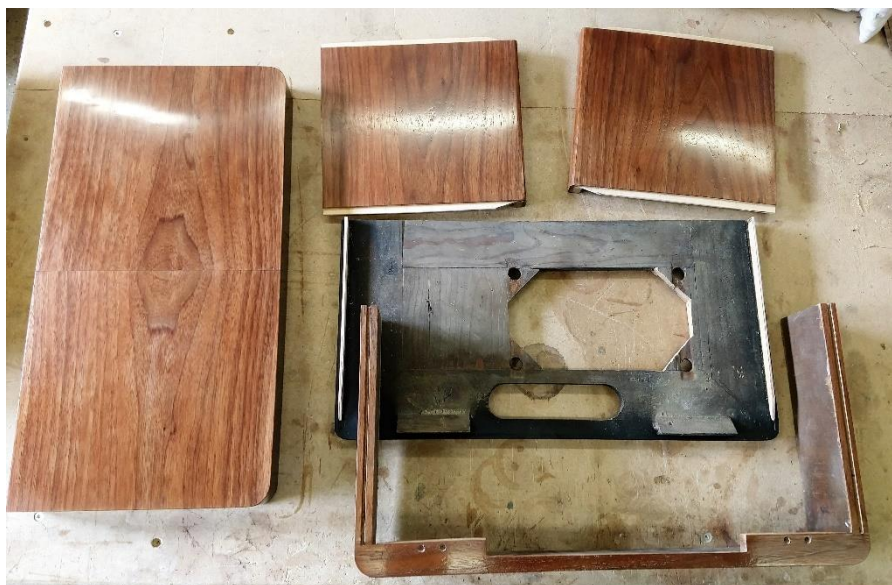
Kabinettet til Master 506 B med ny finér inden det blev samlet. Foto: Preben Skovsen
